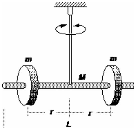
**Fig. 2:** Péndulo constituido por barra y dos pesas
